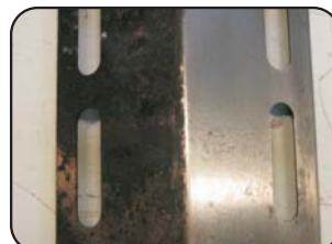
En flametamer (i grill 12213) som var godt brukt og dekket med marinade, matrester, skitt, overflaterust etc. Den øyre siden er rengjort og polert.
