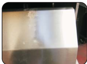
En upolert flate på grill 12713. Lett rødoxidert, fett og gulfarve er fjernet.
